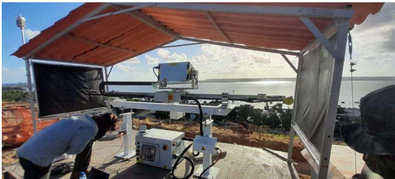
Instalação do radar de abertura sintética em 2D (SAR) do tipo Ground Based SAR (GBSar)
