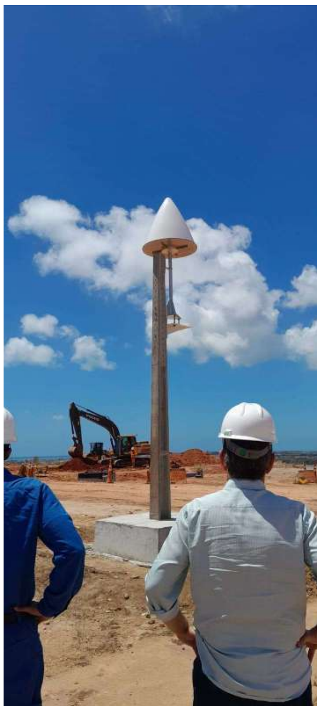
Refletor de canto para aplicações interferométricas
